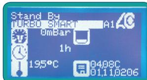
Operando sul tastierino, attraverso semplici e facili operazioni è possibile verificare lo stato di funzionamento dell'impianto. L'aspiratore è dotato di memoria storica degli accadimenti ed una approfondita analisi tecnica consente diagnosi precise di eventuali anomalie.
